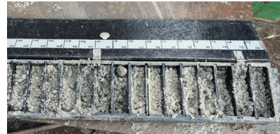
Voorbeeld van de verschillende aardlagen die zijn opgeboord tijdens de proefboring in Zierikzee.
