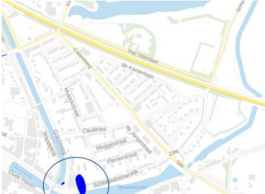
Figuur 2.4 | Verontreinigde situatie Malta, Zierikzee; grondwaterverontreiniging in het blauw en ondergrondse tanks in het rood (bron: zeeland.nazca4u.nl).
