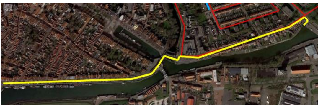
Figuur 3.1 | Inpassing TEO-systeem langs de nieuwe Haven. Deze schets is een variant op de schets gegeven in Figuur 2.12. De lengte van de leiding voor de TEO komt overeen met de lengte van de TEO-leiding uit Figuur 2.12.
