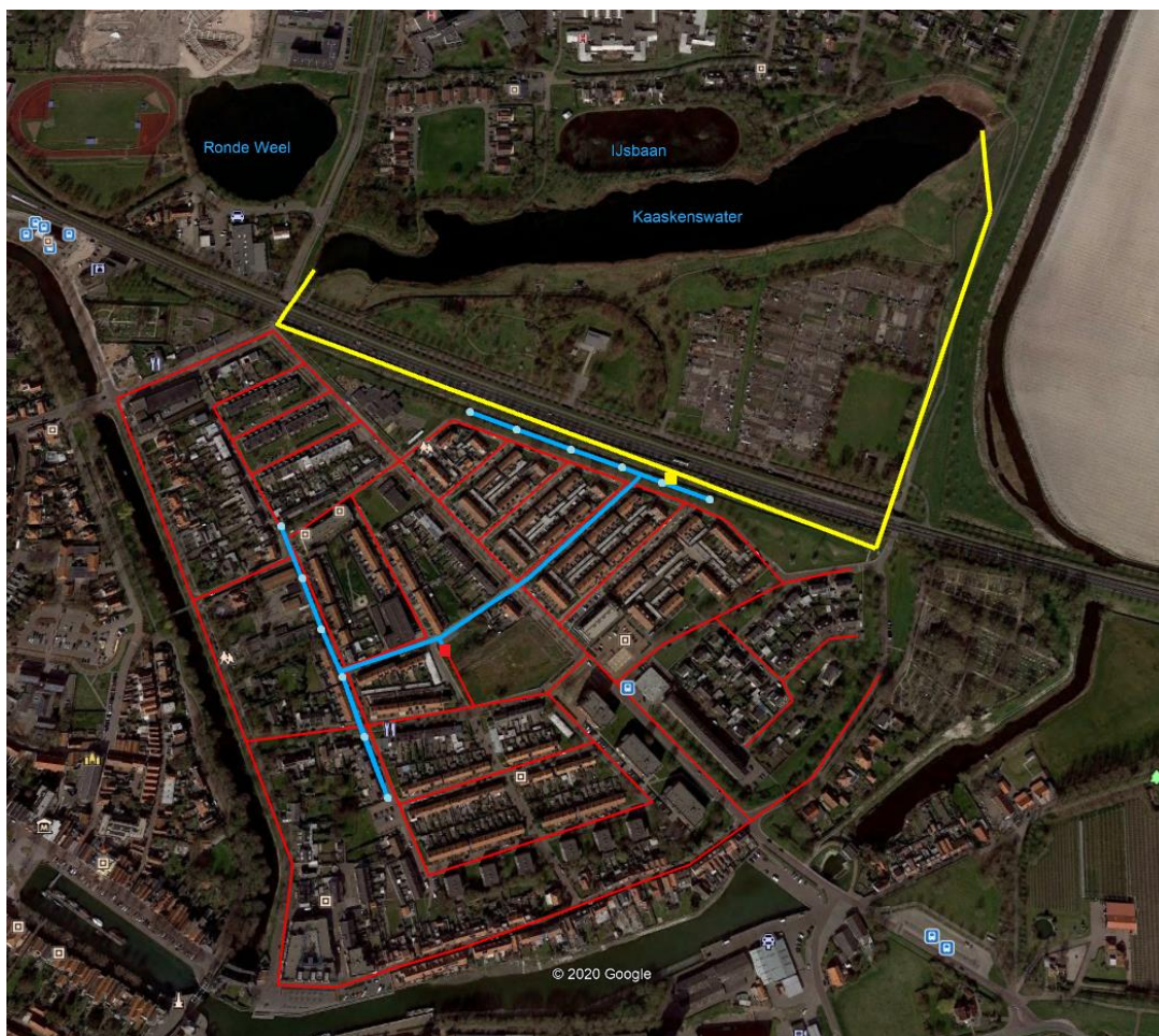
Figuur 2.12 | Schetsontwerp collectieve WKO en TEO met een 70/40 °C warmtenet. De figuur is slechts een voorbeeld van het systeem (haalbaarheidsniveau). In de engineeringfase wordt nadrukkelijk naar inpassing van de verschillende onderdelen gekeken.
