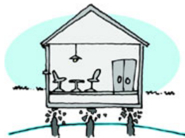
Grondwaterpeil te laag: paalrot
