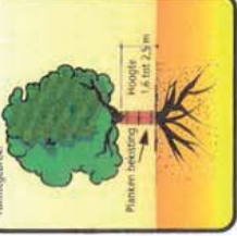
3. Stambescherming Alleen in uitsonderingsituatie (breedte) bij rammeren. Hoogte 1,5 tot 2,0 m
